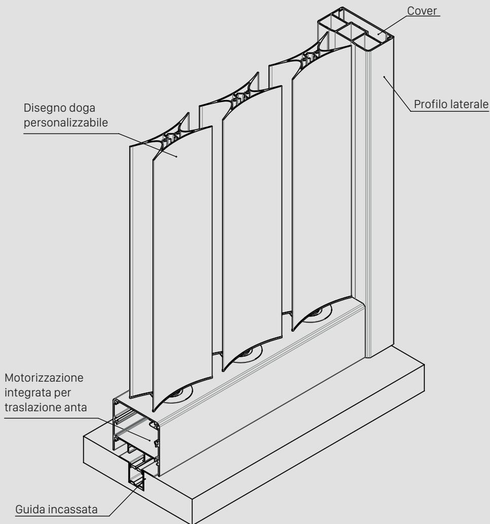
**OSCURAMENTO PERPENDICOLARE:** da 100% a 32% (a passo 110mm, a seconda della doga).
