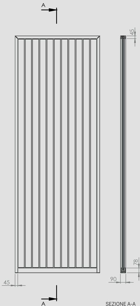
**STRUTTURA:** struttura portante in estruso di alluminio sui 4 lati.
